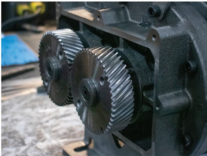
Engrenages hélicoïdaux internes d'une soufflante de la série CP.
