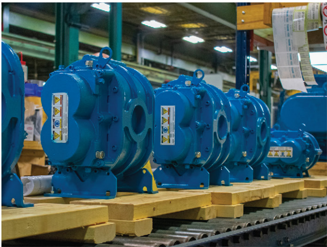
Soufflantes de la série CP sur la chaîne de peinture.
